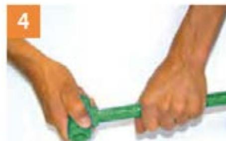
Inserte el tubo hasta la marca tope existente en el accesorio, luego de lo cual deberá cumplirse el tiempo de trabajo marcado ( $t_2$ ) en la tabla No.2, para que el proceso de termofusión haya concluido.
